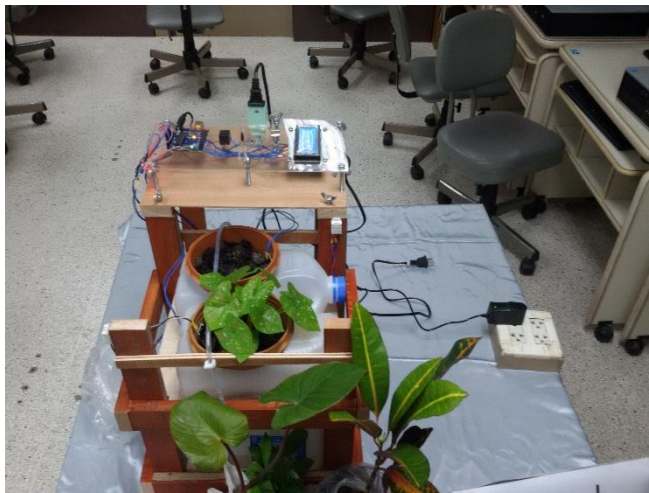
ฐานที่ 3 เครื่องวัดปริมาณความชื้นในดินและการควบคุมปั้มน้ำอัตโนมัติ
